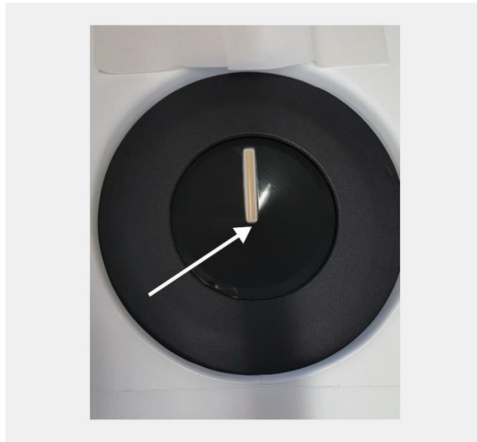
Abbildung 5: Aussparung im SOFIA-Bett mit dem integrierten Scanbereich – vergrößerte Darstellung
